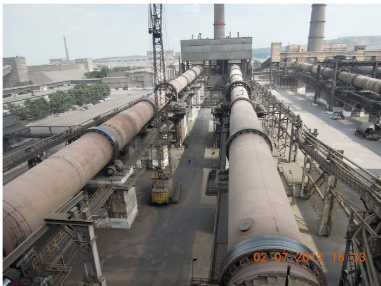
Рис 3. Печи производства цемента по мокрому способу длиной 180 м
